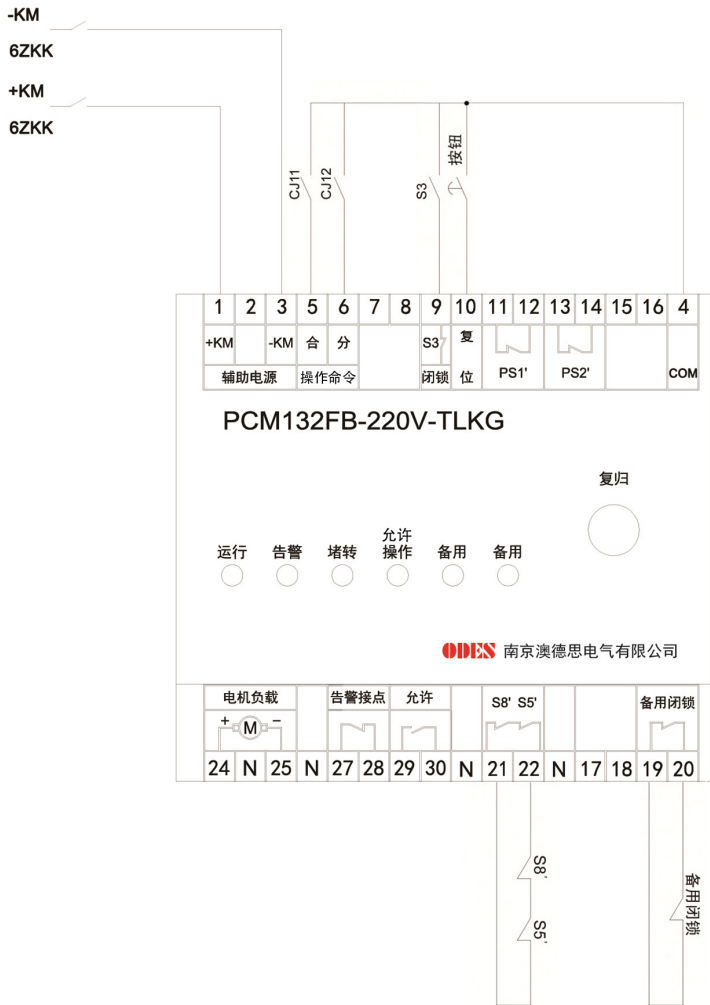
二工位控制器接线图(公共端位置需要用户重点确认)
